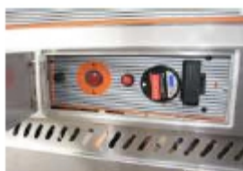
Система розжига защищена заслонкой
